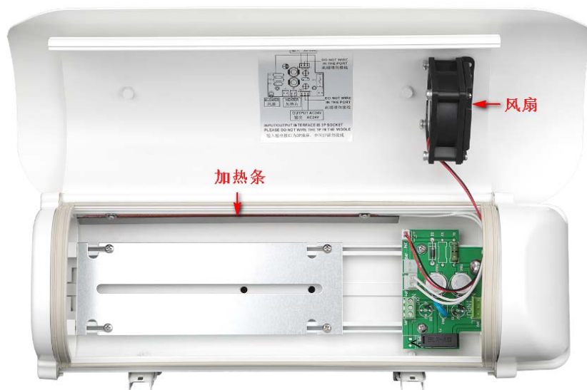
图1-31 室外增强型护罩加热条、风扇电源线接线示意图
